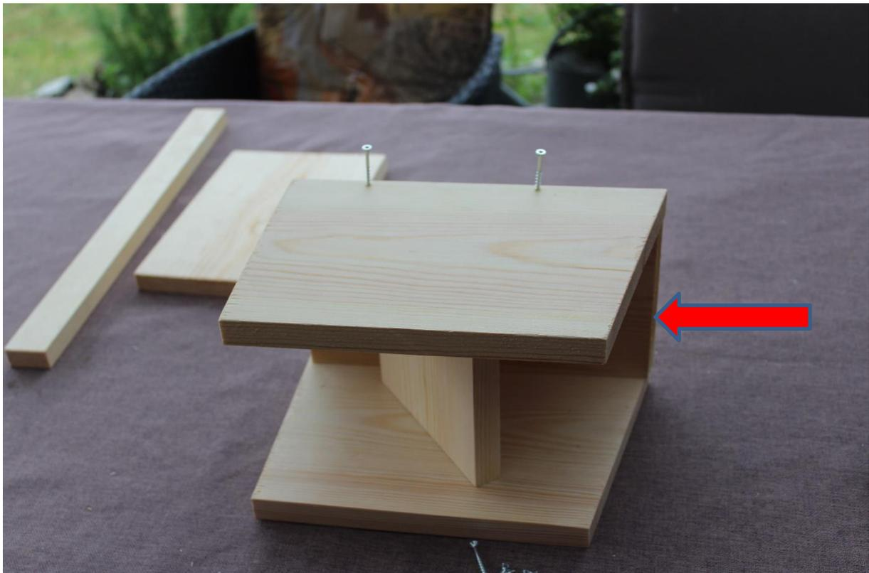
Als erstes wird die Rückwand mit den Seitenteilen verbunden, dafür am besten den Fußboden zwischen die Seiten stellen, so hat man etwas Halt. Bitte darauf achten, dass die abgeschrägte Kante der Rückwand richtig herum nach oben zeigt. Nun zwei Schrauben/Nägel eindrehen/einschlagen.
