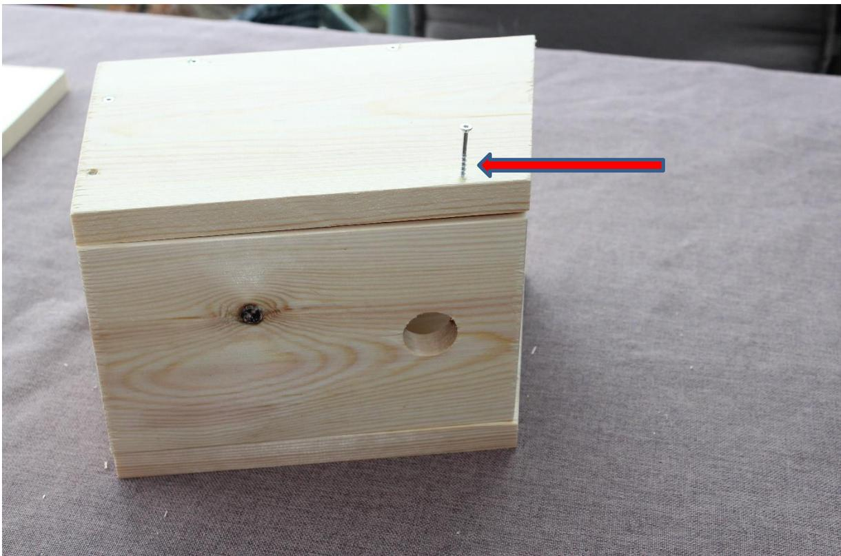
Nun die Vorderfront einsetzen, dafür nur zwei Schrauben/ Nägeln 3,5 cm von oben einsetzen, damit man die Klappe zum Reinigen öffnen kann.
