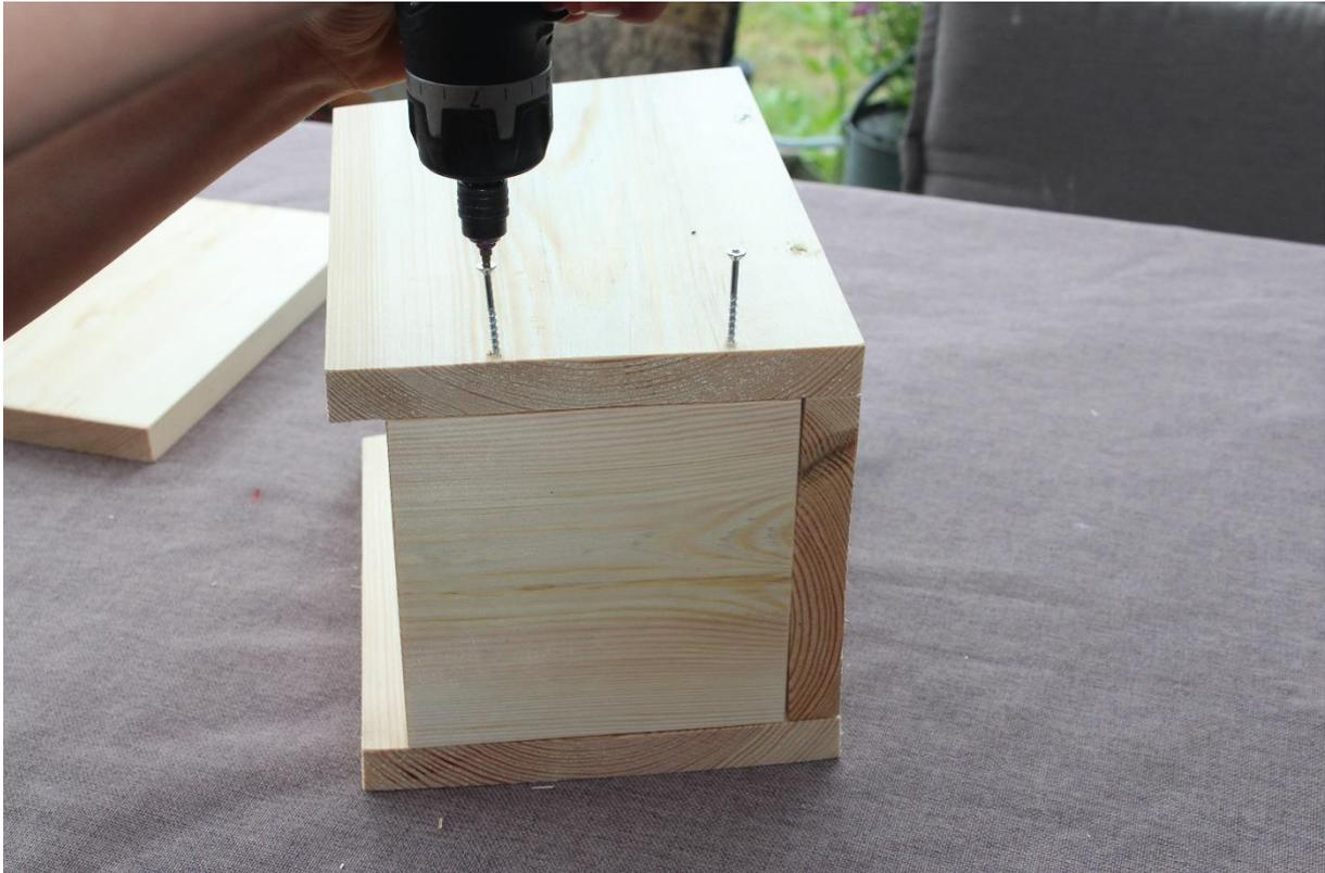
Jetzt den Fußboden in Position schieben und befestigen. 2 Schrauben/Nägeln von den Seiten reichen.
